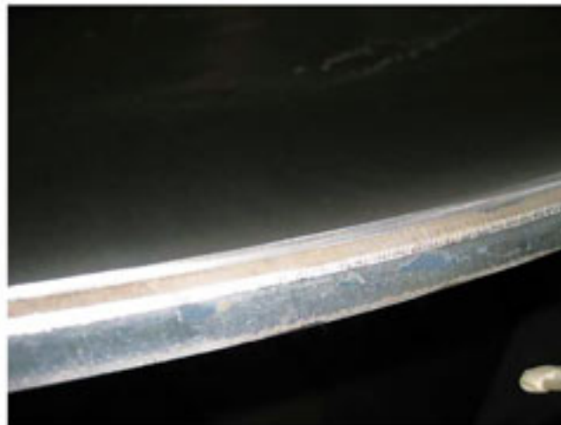
Schweißkantenvorbereitung am plattierten Blech
