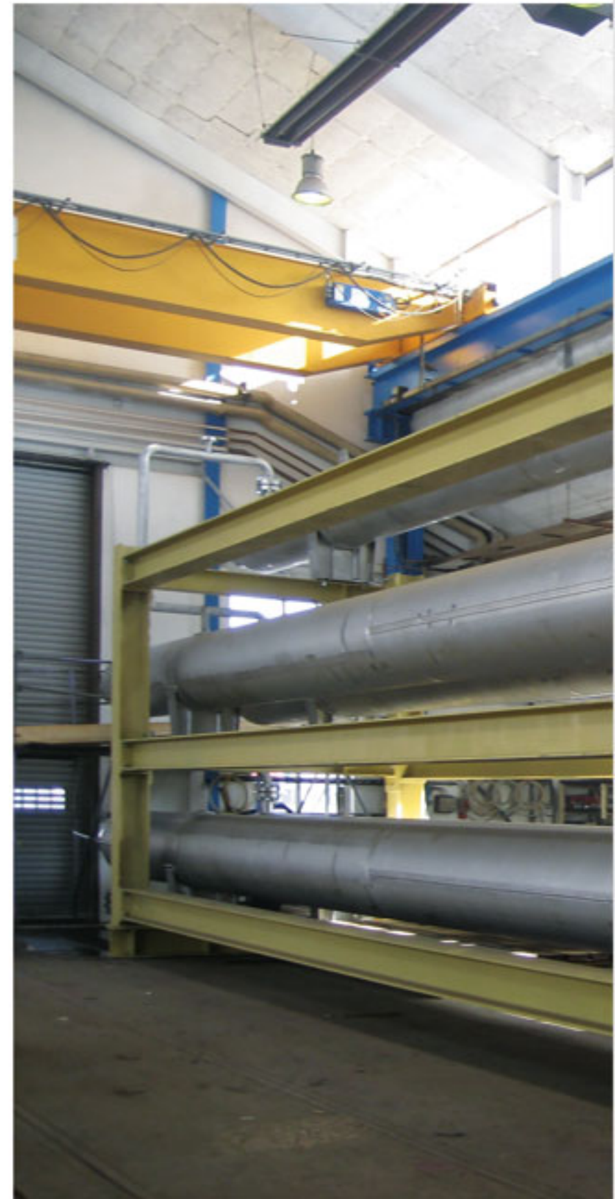
Druckreaktor, 5 x DN 700, Länge: 17270 mm, Werkstoff: SA240-316 mit ASME U Stamp und Manufacturer License
